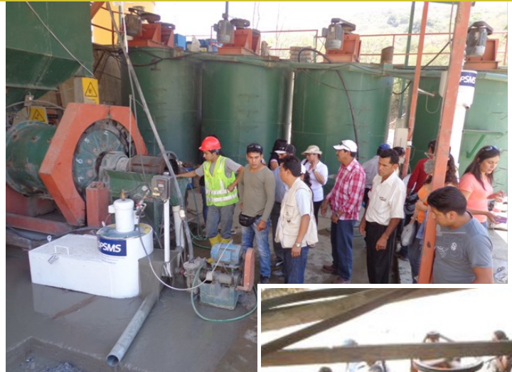
Arriba: Mineros aprenden métodos para mejorar la molienda. Derecha: Mineros observan una sistema de flotación para la concentración de minerales. Fotos: Marcello Veiga.
