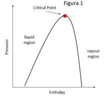
refrigerante en el punto crítico del mismo, tal como se ilustra en la figura 1, que es un diagrama de la relación entalpía-presión para un refrigerante. La eficiencia del ciclo de un aire acondicionado dependerá de que la temperatura de condensación no sea demasiado cercana a la temperatura crítica. La temperatura de condensación siempre es más alta que la temperatura ambiente, por lo que la temperatura de condensación en condiciones de alta
