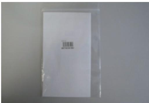
Fotografía 8. Colocar el sobre en una bolsa con cierre hermético.
