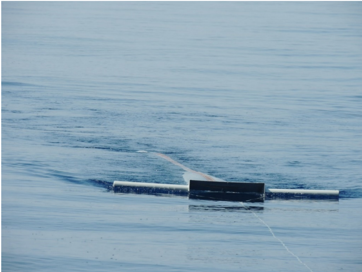
Figure 3 : Filet manta utilisé en mer calme, en dehors de la vague d'étrave causée par la rotation de l'hélice (Photo : © Christos Ioakeimidis, PNUE/PAM).
