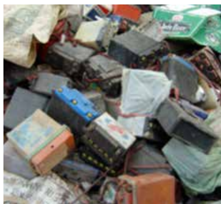
Fig. 10: Exemples d'un stockage de batteries au plomb usagées incorrect 25
