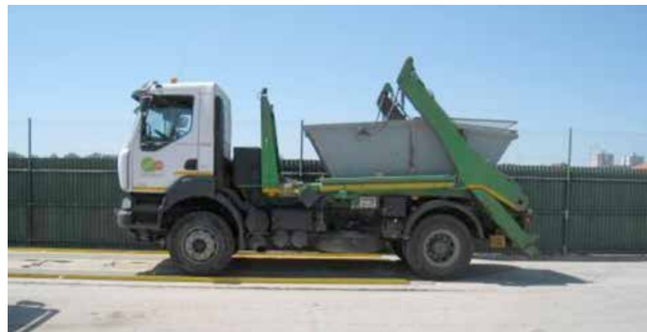
Fig. 37: Pesage du conteneur lors de l'admission à la décharge
