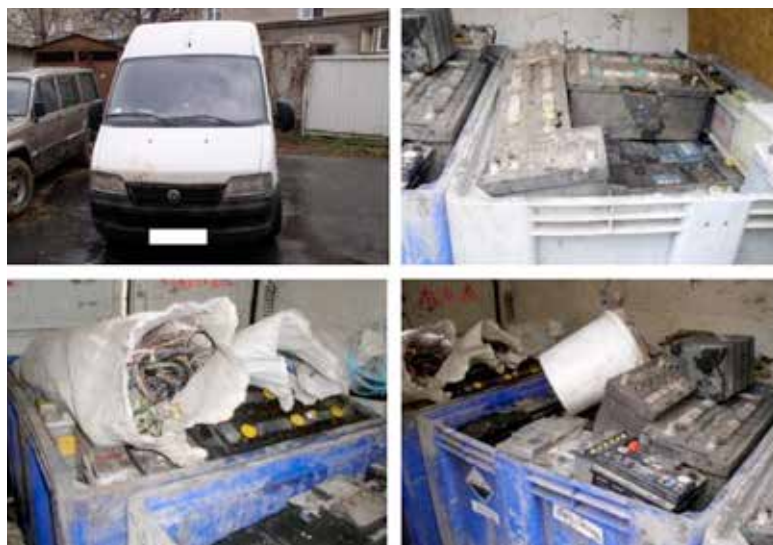
Fig. 42: Exemples des conditions de transport incorrectes et inacceptables
