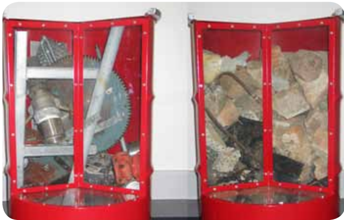
Embalaje y almacenamiento provisional de residuos radiactivos. Fuente: Autoridad de Desmantelamiento Nuclear del Reino Unido
