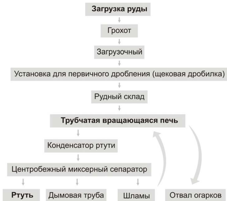
Рис 5 Технологическая схема переработки руды на металлургическом заводе
