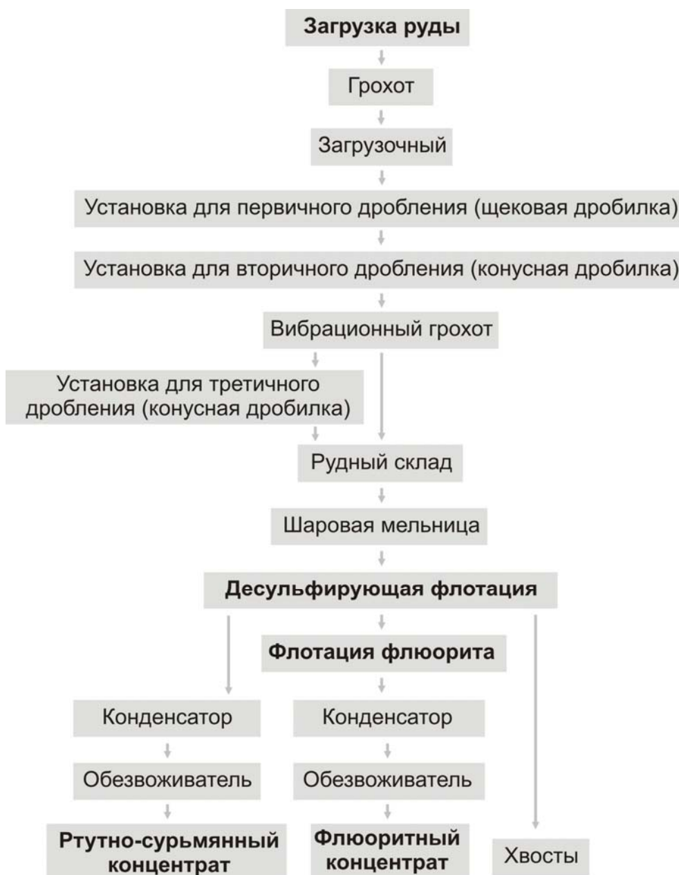
Рис 4 Технологическая схема обогатительной фабрики Хайдарканского комбината
