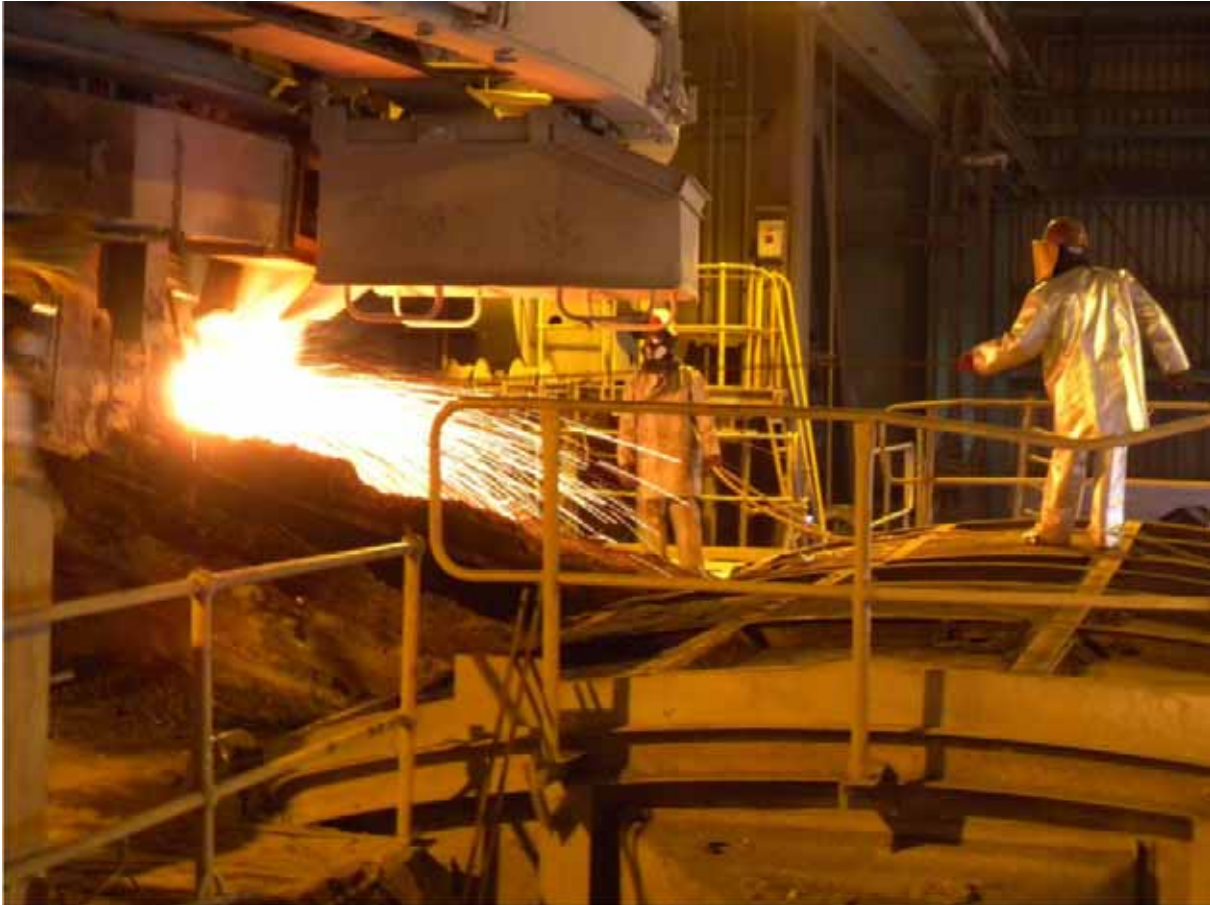
La ferraille des rejets miniers issus de la « Big Hill » de la STL sont recyclés dans un four à haute température. Ils sont transformés en métal liquide, puis granulés en alliage de cuivre-cobalt par les travailleurs portant des tenues ignifugées
