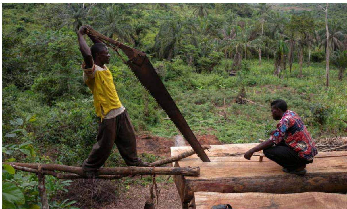
Ne comptant que sur la force de ces bras, un homme se balance sur une bûche pour la couper avec une longue scie à deux poignées dans une forêt-galerie près de Kasasa au Kasai Oriental. Les fosses d'abatage sont l'un des principales techniques utilisées par les exploitants forestiers artisanaux. Scier en planches un arbre peut occuper quatre hommes pendant deux semaines
