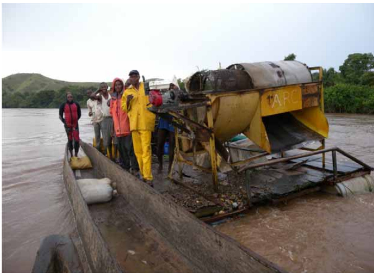
Les plongeurs utilisent des petites dragues d'aspiration pour pomper les petits graviers au fond des fleuves comme c'est le cas le long de la rivière Sankuru dans le Kasai Oriental. Ce travail est extrêmement dangereux en raison du risque d'effondrement des fosses sous-marines. Des rapports font ainsi état de la mort par asphyxie de plusieurs plongeurs. De plus, les dragues mal utilisées peuvent dégrader l'environnement fluvial
