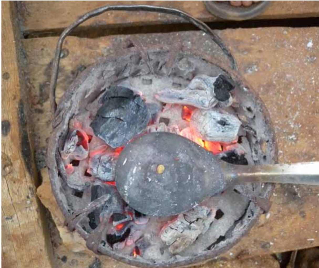
Un morceau de lingot d'or est chauffé sur un four à charbon. Les émissions de mercure peuvent être réduites en équipant les fours avec des hottes. Celles-ci peuvent également être utilisées à des fins de recyclage
