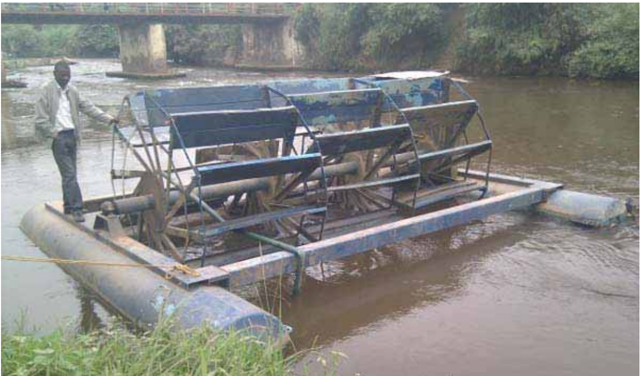
Au vu de l'énorme potentiel hydraulique de la RDC, la CNE exécute des tests d'hydroliennes. Ces hydroliennes ont l'avantage de ne pas nécessiter de lourds travaux de génie civil, sont faciles à installer, et moins chères comparativement aux microcentrales hydroélectriques. L'hydrolienne illustré ci-dessus a une puissance de 5,5 Kilowatt.
