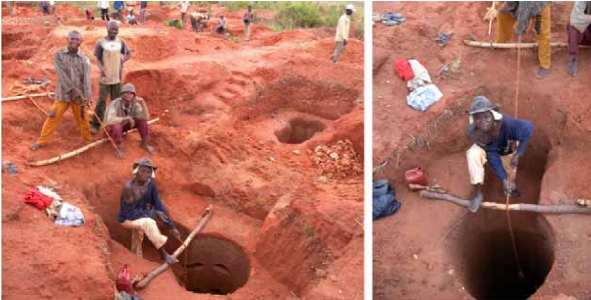
La remontée d'un sac de terre d'une mine de diamants à Kabala, près de Mbuji-Mayi. Certains des tunnels creuser à la main peuvent atteindre des profondeurs allant jusqu'à 35 mètres
