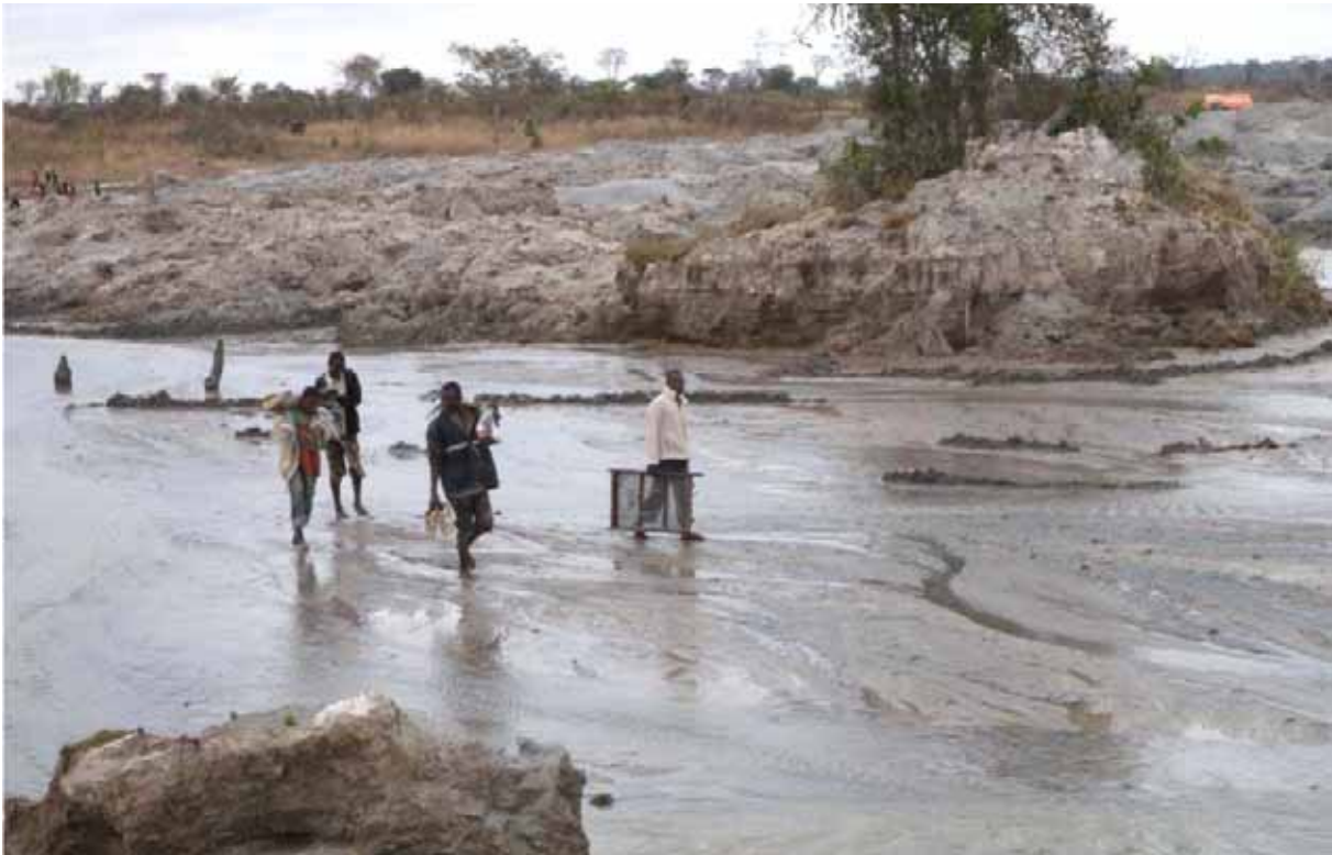
Les rejets miniers issus de l'usine de traitement Mutoshi de la Gécamines sont uniques, en ce sens qu'ils ont été directement rejetés dans la rivière Kulumaziba. Ils s'étendent en aval sur une distance d'environ 17 km et à des profondeurs allant jusqu'à trois mètres et contiennent environ 1.5 millions de tonnes de malachite grossière d'une concentration de 6.8% en cuivre
