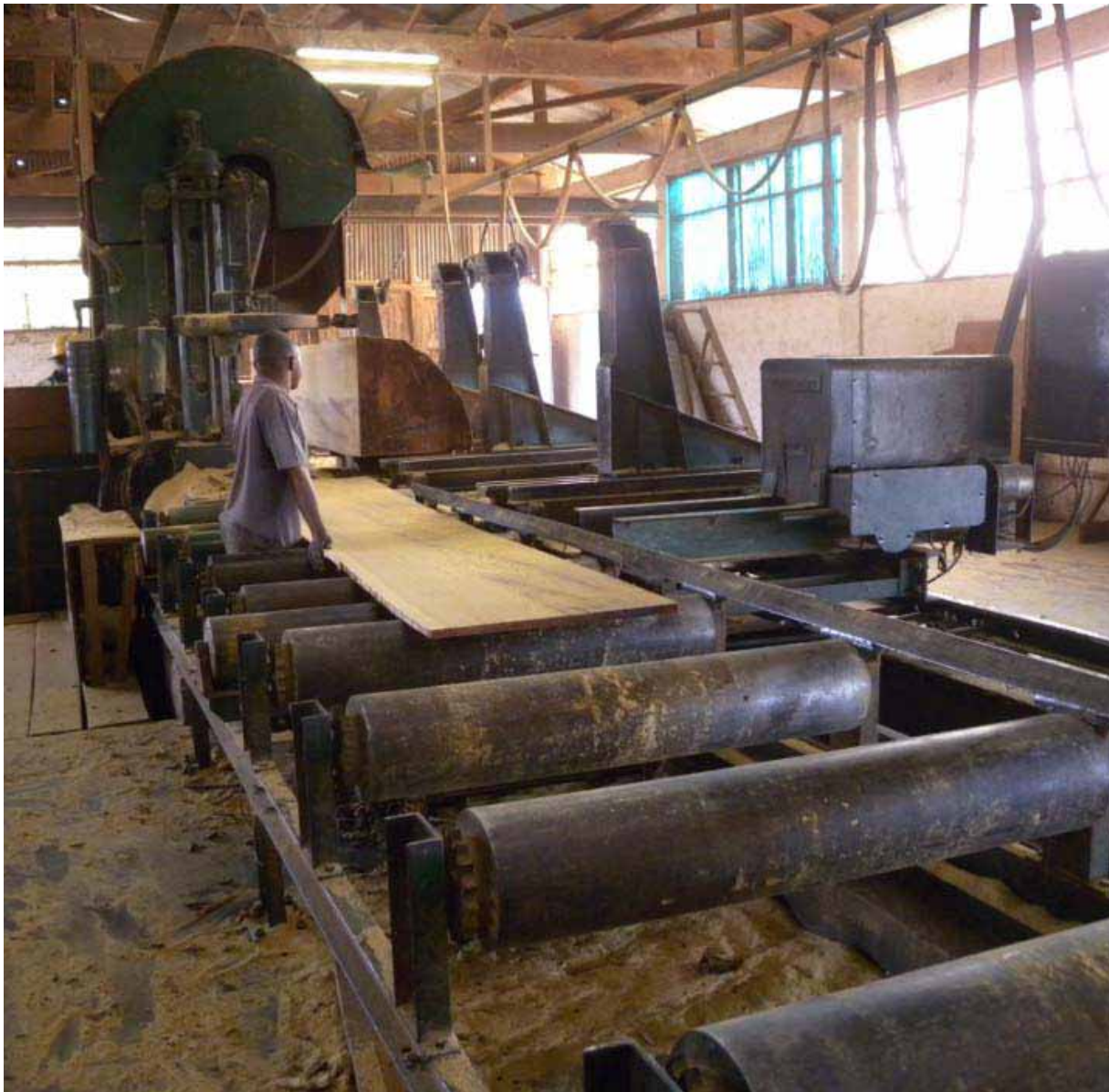
Une machine de la scierie coupe une grume en planches à la concession de la société ENRA à Beni au Nord Kivu
