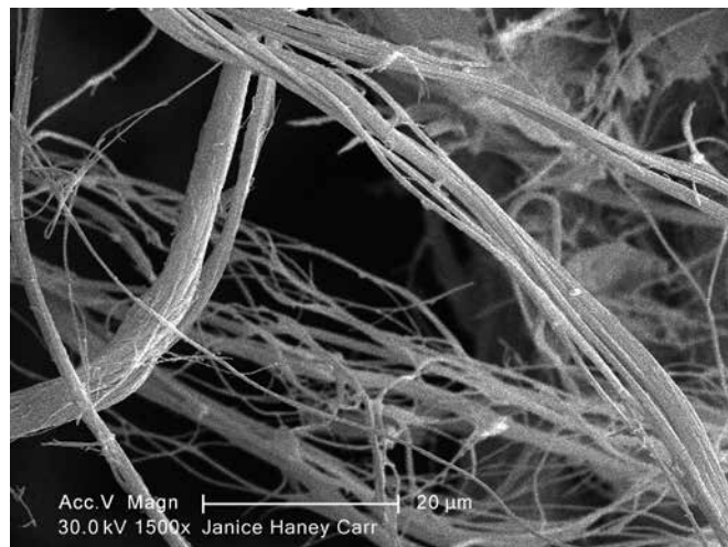
在扫描电子显微镜下放大1500倍的石棉纤维
