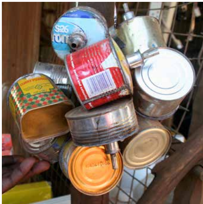
用回收罐制成的煤油灯芯灯
