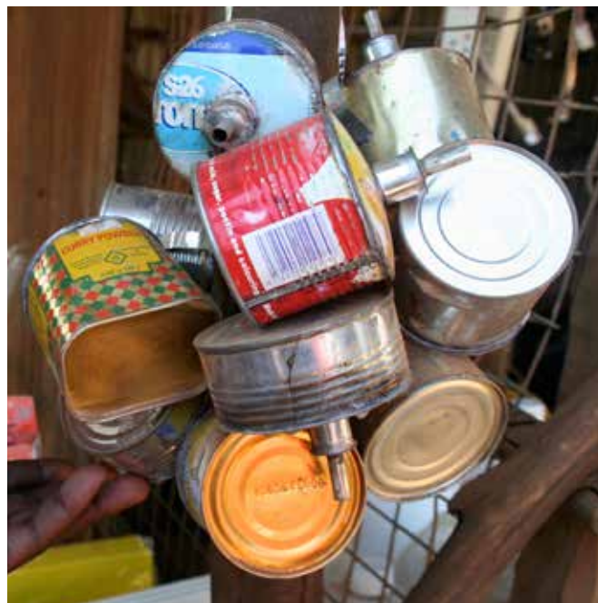
Lampes à pétrole à mèche faites de boîtes de conserve recyclées
