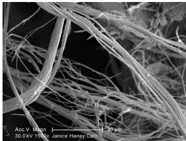
Fibres d'amiante grossies 1 500 fois par microscopie électronique à balayage
