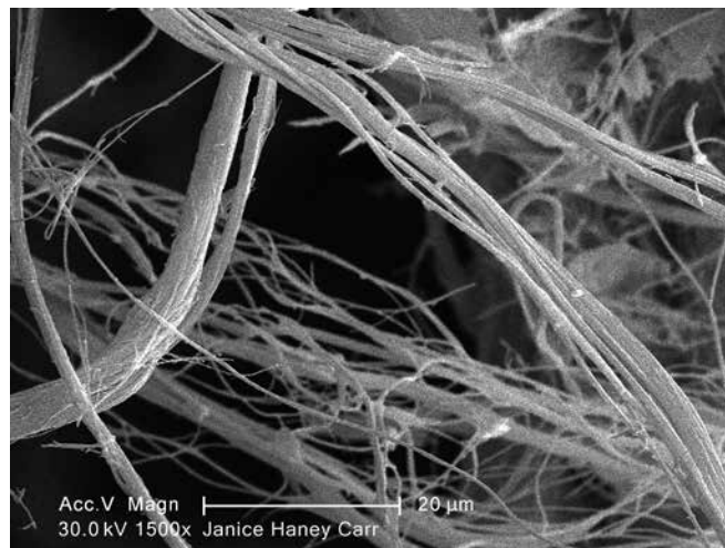
Волокна асбеста при увеличении в 1 500 раз с помощью сканирующего электронного микроскопа
