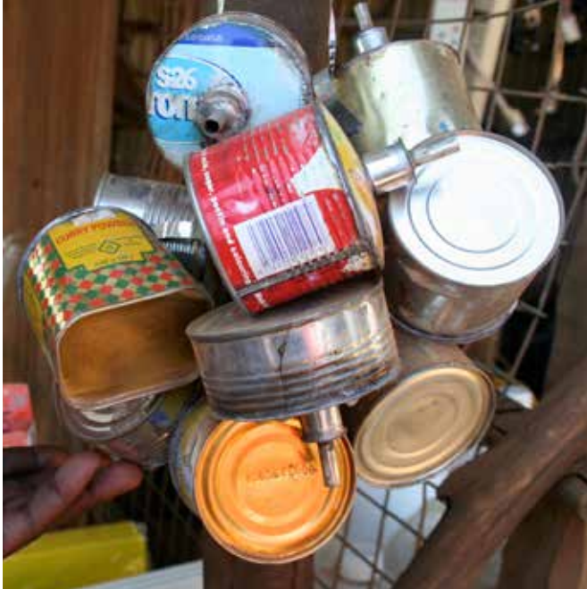
مصابيح فتيال عاملة بالكبروسين مصنوعة من علب قنديرية معاد تدويرها مقدمة من إيفان ميلز
