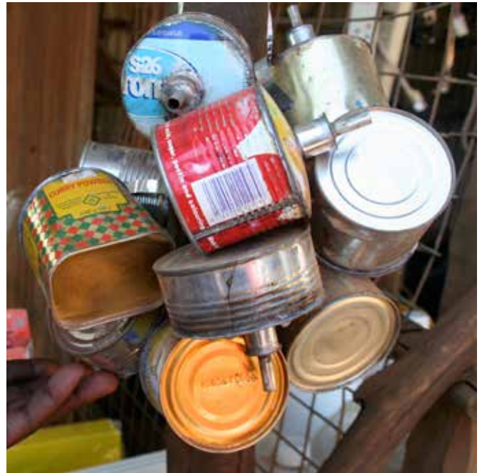
用回收罐制成的煤油灯芯灯 Evan Mills供图
