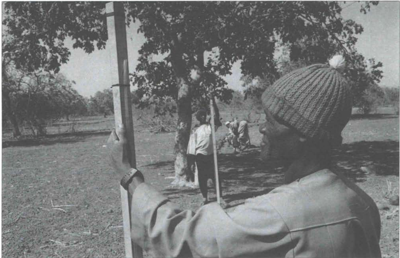
Burkina Faso: Mesurage des courbes de niveau pour construire des lignes en pierres et ainsi prévenir l'érosion du sol
