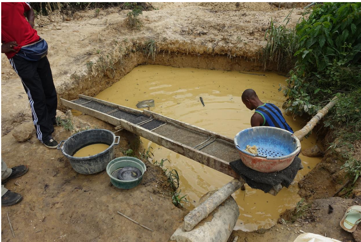
Photo 21 : À Kafiwema, la pente de cette rampe de lavage pourrait être optimisée et les deux sections de la rampe devraient être disposées en configuration L ou Z pour forcer le débit à s'arrêter et à redémarrer (la majeure partie de l'or est prise dans le premier mètre de la rampe, faire un virage rendrait plus efficace la longueur utile de la rampe)
