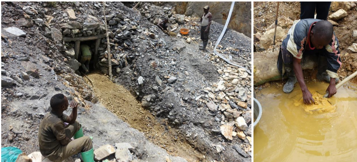
Photos 4 et 5 : Les entrées rudimentaires de la mine et les tunnels sont parfois renforcés par des poutres de bois, mais ces supports sont peu nombreux et les tunnels sont enclins à s'effondrer. Mineurs lavant le minerai dans des pelles pour évaluer la teneur en or dudit minerai.
