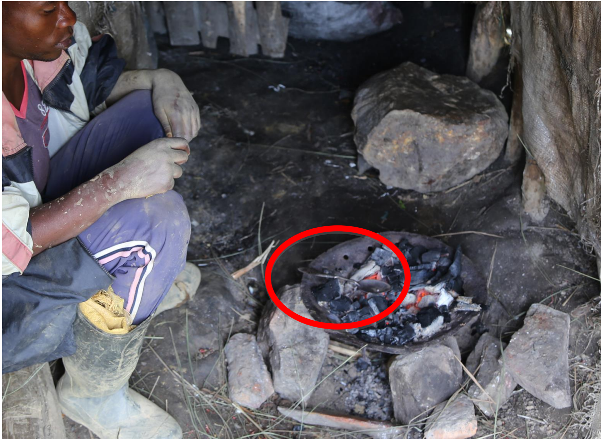
Photo 9 : Brûlage à ciel ouvert de l'amalgame d'or avec une cuillère à soupe sur le poêle à charbon
