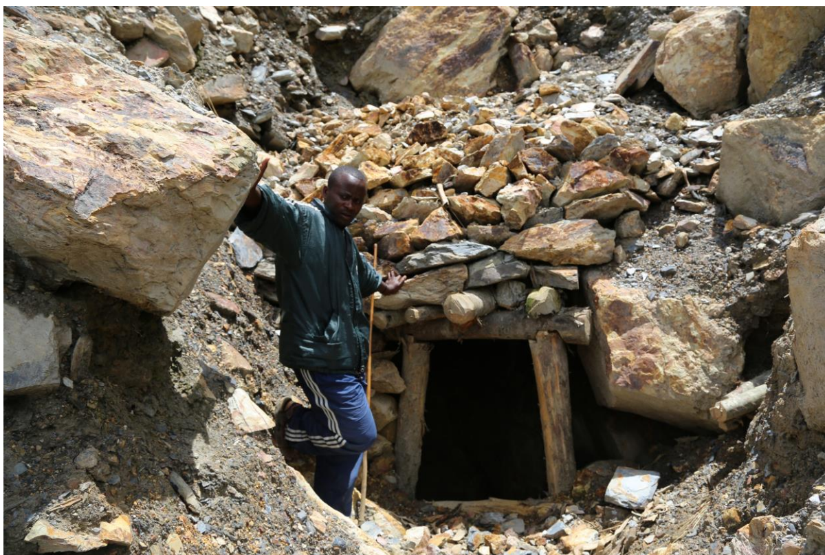
Photo 30 et 31 : Un récent glissement de terrain suite à de fortes pluies a détruit plusieurs tunnels miniers
