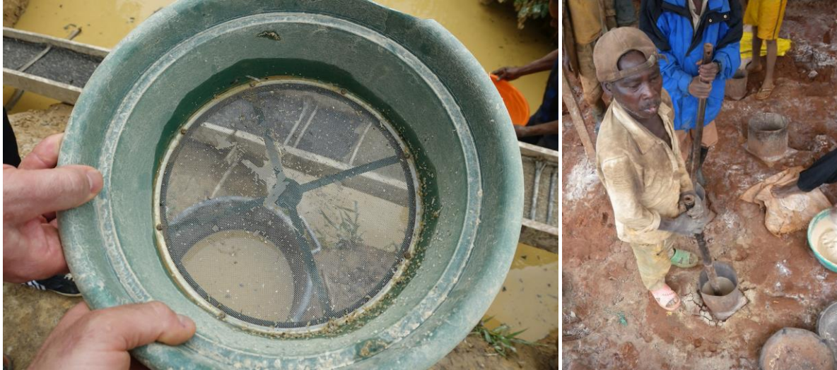
Photos 19 et 20 : Ceci (à gauche) est probablement un maillage approprié pour le minerai de Kafiwema (environ 1 mm), au moins pour le broyage primaire. Les analyses granulométriques indiqueraient mieux la taille optimale. Broyage secondaire au mortier et au pilon (à droite)
