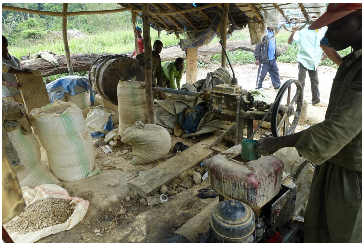
Photo 17 : Cet ancien moteur diesel doit régulièrement être alimenté en huile neuve pour être maintenu en marche. La capacité des mineurs à improviser ce système archaïque de broyeur fonctionnel démontre leur capacité à apprendre à manipuler des équipements pour des meilleures pratiques
