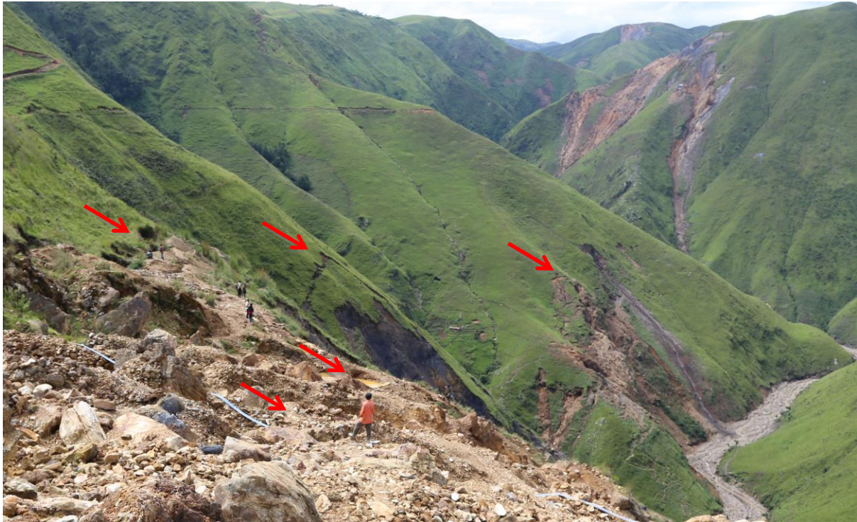
Photo 3 : Entrée de la mine de Butuzi. Remarquez la frange d'herbes sur les puits de collecte des eaux pluviales, à l'extrémité gauche de la photo, à la marge supérieure de la perturbation, et le tuyau qui amène l'eau par gravité aux écluses ci-dessous. Au-dessus de la personne en rouge se trouvent trois bassins d'amalgamation pleins de boue jaunâtre. Les chutes de déchets gris et rouge sont visibles à droite du centre, et les fissures de glissements de terrain à gauche du centre. La rivière ci-dessous est pleine de mineurs alluvionnaires tous les jours, durant toute l'année.
