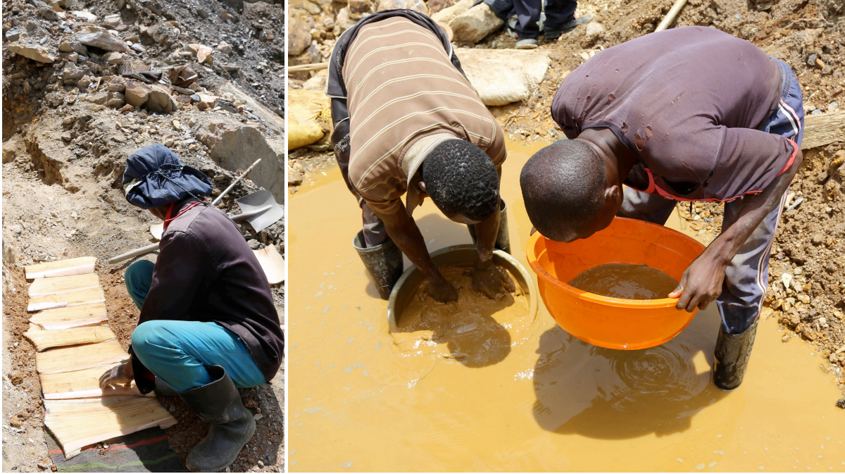
Photos 10 et 11 : L'écorce de banane sert de concentrateur effectif d'or, mais inefficace (à gauche). Des tapis appropriés et moelleux, sur un plan de lavage incliné à 10° seraient plus efficaces pour capturer l'or. Les bassines en plastique servent de concentrateurs d'or relativement pauvres, et les écuelles à or appropriées seraient plus efficaces
