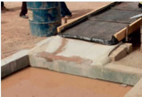
Balsa para relaves libre de mercurio y reciclado del agua
