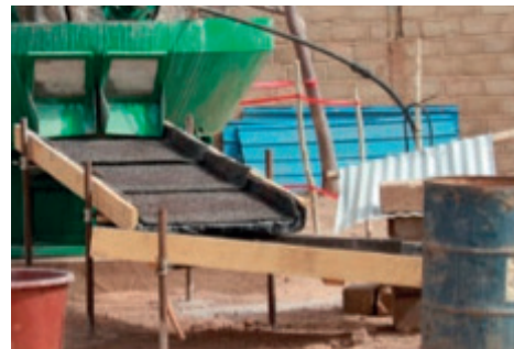
Criba de molino triturador en húmedo y esclusas, a continuación tapiz de lavado y batea
