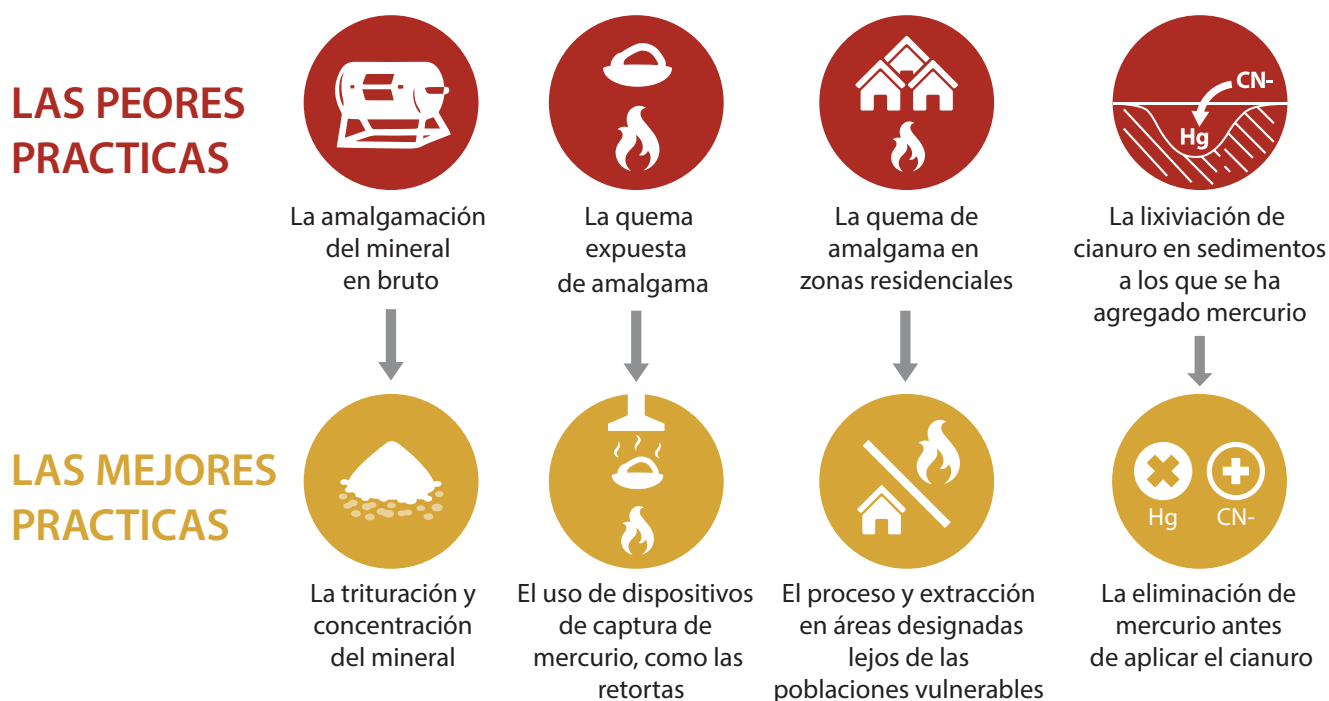
Figura 2. Las peores prácticas según la Convención de Minamata y acciones recomendadas para mejorarlas. (Adaptado de la infografía PNUMA/GEF GOLD 5 )
