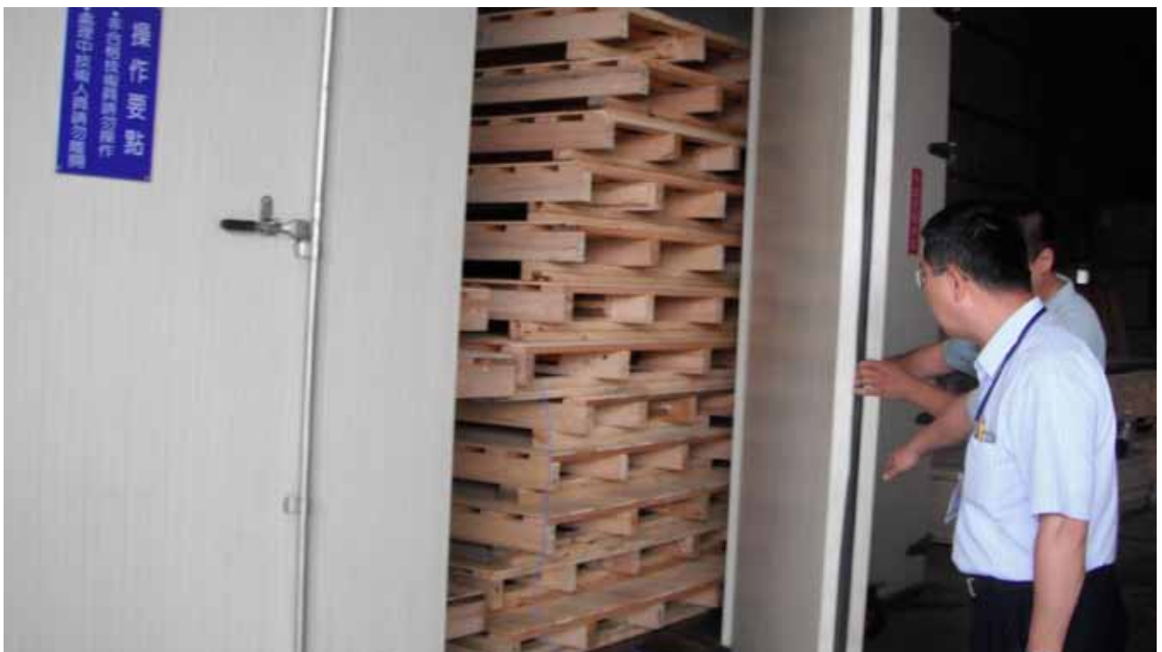
Cámara para tratar embalajes de madera con calor, China
