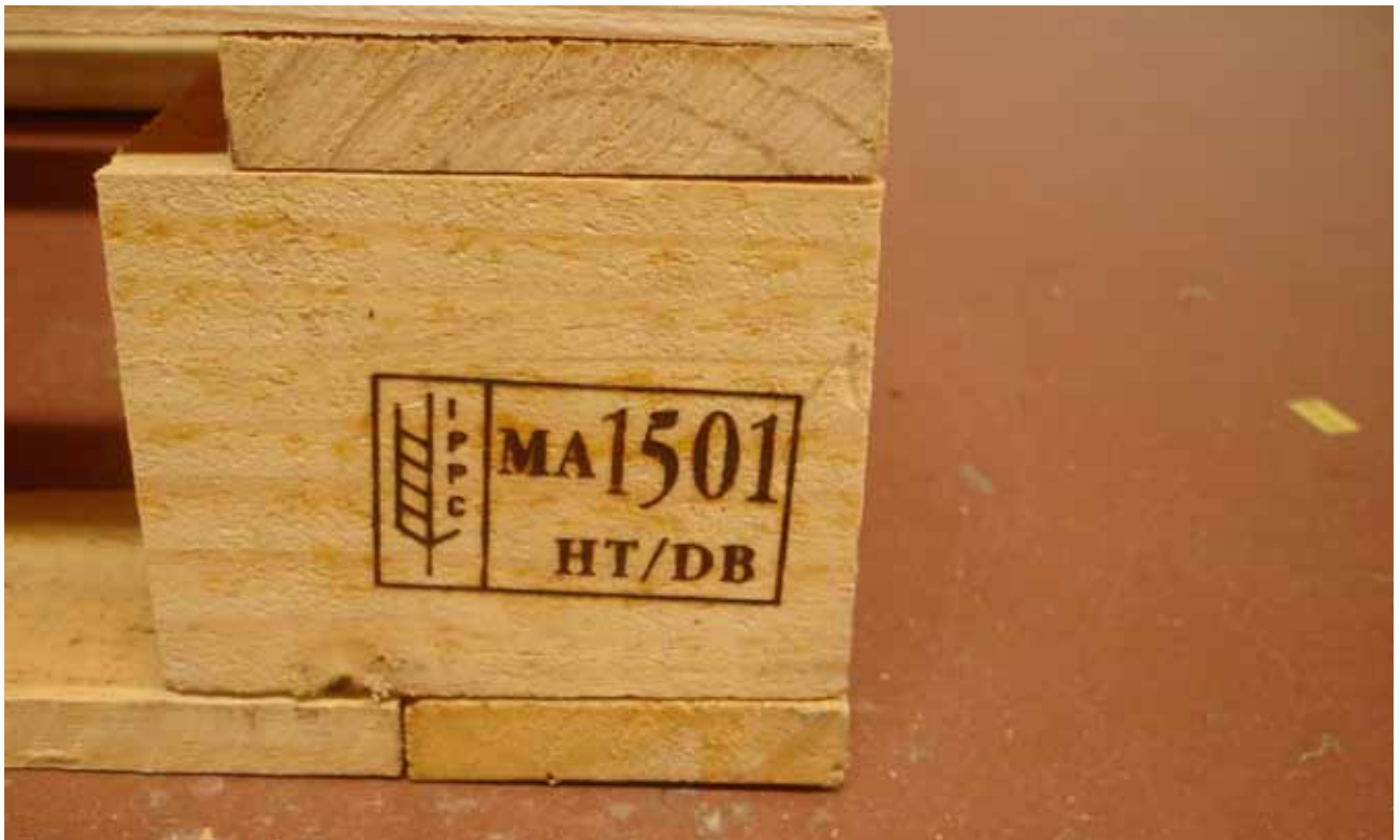
Embalaje de madera de Marruecos con el sello requerido por la CIPP que muestra que fue tratado con calor
