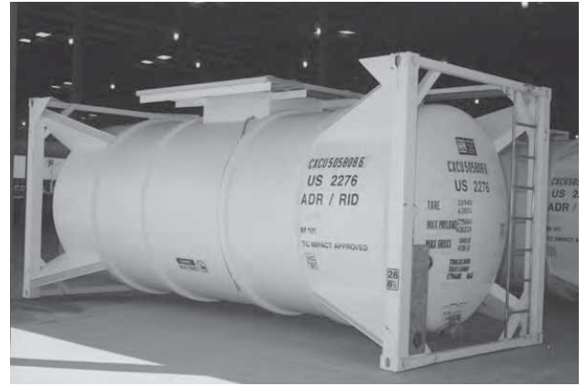
Photo 6-16 - Les réservoirs ISO permettent le transport multimodal de grandes quantités de frigorigènes
