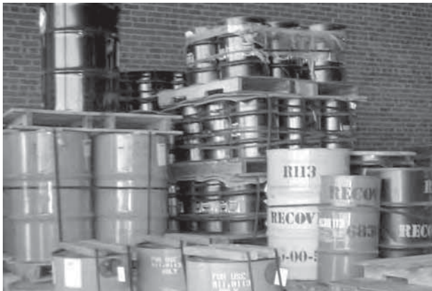
Photo 6-11 – Divers contenants à faible pression
