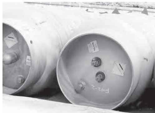
Photo 5-4. Vue des robinets d'accès des petites bouteilles contenant du HFC-134a.
