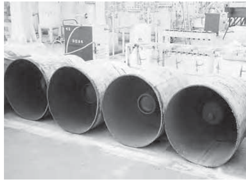
Photo 5-2. Vue des petites bouteilles de HFC-134a après avoir pratiqué une ouverture dans les barils et avoir retiré tout le frigorigène CFC-12.
