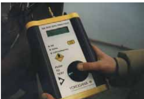
Photo 7-1a et 7-1b. Deux identificateurs de frigorigènes différents (note : le R-134a n'est pas une SAO).
