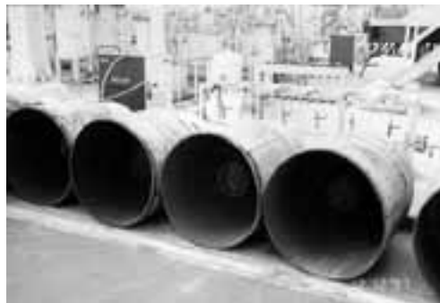
Фото 5-2. Вид малых баллонов с ГФУ -134а после удаления хладагента ХФУ-12 и вскрытия основных контейнеров.
