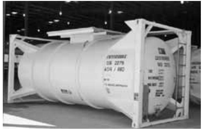
Фото 6-16. Цистерны ISO позволяют осуществлять смешанные перевозки большого количества хладагентов.
