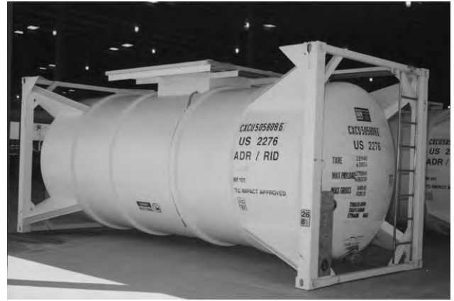
Foto 6-16 - Tanque ISO que permite transporte multimodal de cantidades elevadas de refrigerantes
