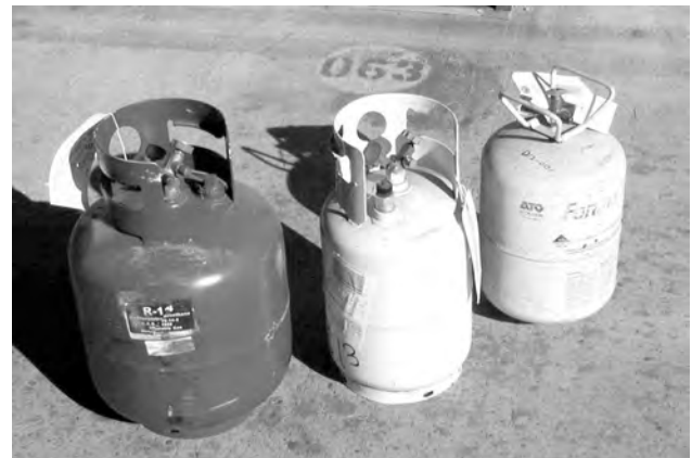
Foto 6-12 - Cilindros reutilizables de 50 (22,7 kg) y 30 lb (13,6 kg); cilindro desechable de 30 lb (13,6 kg).
