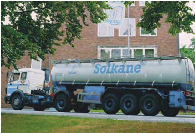
Foto 6-19 - Camión cisterna usado para transportar grandes cantidades a granel de HCFC-141b
