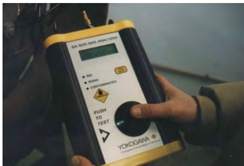
Photo 7-1a and 7-1b. Dos identificadores de refrigerante diferentes (recuerde que el R-134a no es una SAO)
