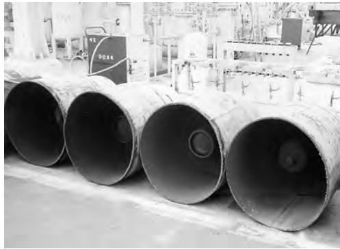
Foto 5-2. Vista del pequeño cilindro de HFC-134a después de haber extraído el refrigerante CFC 12 y abrir los contenedores mayores.
