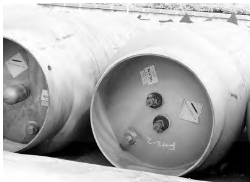
Foto 5-4. Vista de las válvulas de acceso del pequeño cilindro conteniendo HFC-134a
