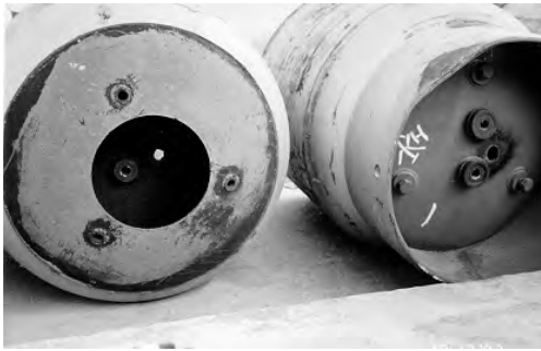
Foto 5-1. El punto de acceso al contenedor principal de CFC-12 fue visible solo después de abrir el contenedor de doble piso.
