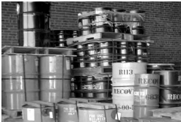
Foto 6-11 - Varios contenedores de baja presión
