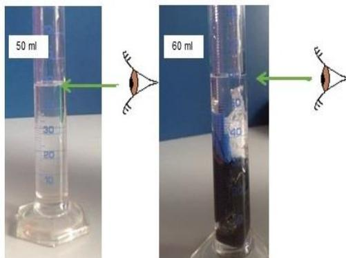
**Figure 11:** Le volume des déchets plastiques correspond à la différence entre le volume avec (droite) et le volume sans (gauche) déchets plastiques. Le volume se lit en considérant la base du ménisque formé par la surface de l'eau.
