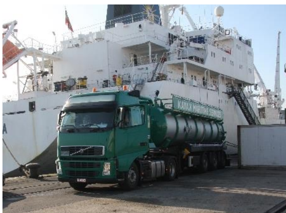
Camión sistema recogiendo residuos oleosos (Foto:
