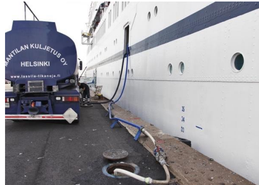
Recogida de aguas residuales en el puerto de Helsinki (Finlandia) (Foto: Clean Baltic)
