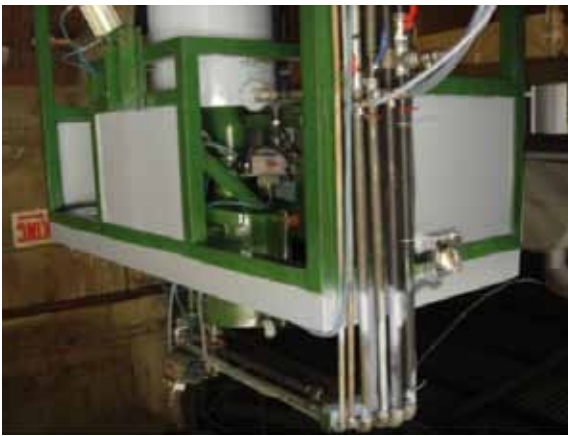
ماكينة صنع المواد الرغوية للصناديق المصممة والمصنعة محلياً من قبل باماك نيجيريا المحدودة
