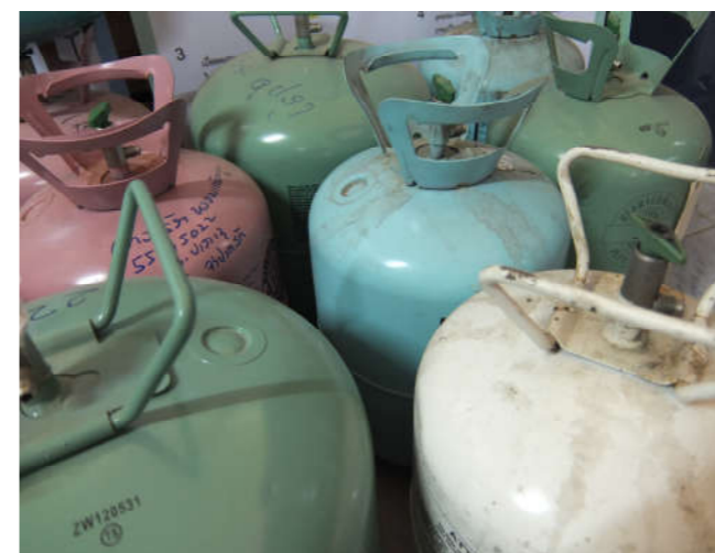
Colores de cilindros para refrigerantes conocidos: CFC-12 = blanco, HCFC-22 = verde suave, HFC-134a = azul cielo suave, R-410A = rosa
