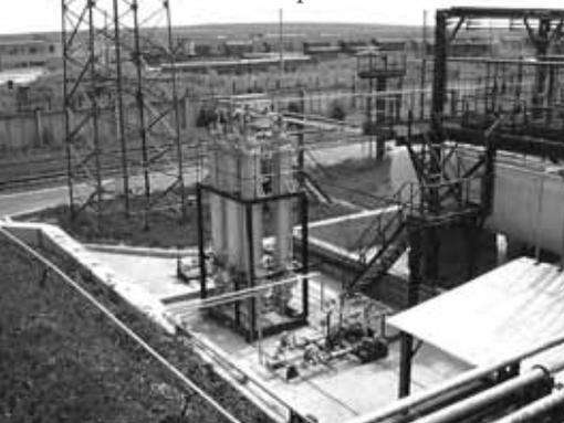
El punto de penetración no afecta en modo alguno la capacidad total de adsorción. En el caso de que se cuente con más de una columna, la columna que alcance la penetración puede quedar en línea y, eventualmente, adsorberá su más del 20% de contaminantes, o hasta alcanzará el 30%. Sin embargo, con tan sólo una columna, deben instalarse nuevos pellets y emplearse tan pronto como se alcance el punto de penetración, independientemente del porcentaje de utilización.
