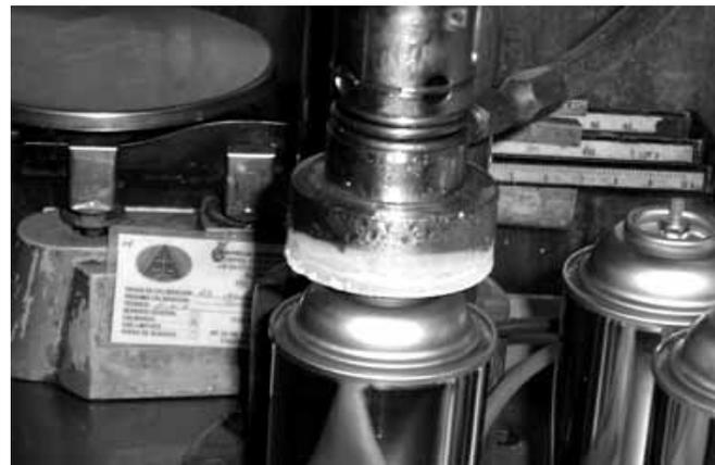
En este adaptador de gaseado hay un anillo sólido de hielo. Se trata de una filtración peligrosa. Es necesario detener la máquina y cambiar las juntas.
