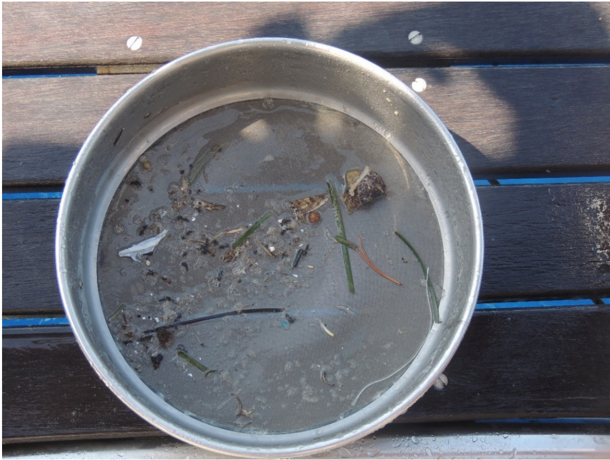
Figure 3 : Microplastiques et matières organiques recueillis dans un tamis en métal juste après le prélèvement (Photo : © Christos Ioakeimidis).
