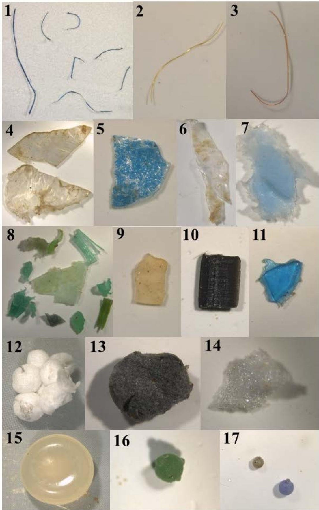
Figure 4 : Formes courantes des microplastiques. (1 : fibres, 2-3 : filaments, 4-7 : films, 8-11 : fragments, 12-14 : mousses, 15 : pastille, 16-17 : granule) (Photo : © Ülgen Aytan, Turquie).
