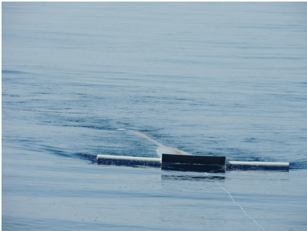
Figure 1 : Filet manta utilisé en mer calme, en dehors de la vague d'étrave causée par la rotation de l'hélice (Photo : © Christos Ioakeimidis, UNEP/PAM).
