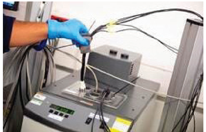
Fig. n°12 : Vérification métrologique d'un enregistreur de température à sonde externe
