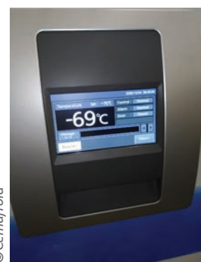
Fig. n° 10 a) : Armoire réfrigérée pour la conservation des vaccins à l'hôpital et b) son panneau de contrôle
