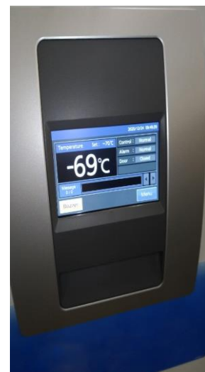
Рис. 10 а) Холодильный шкаф для вакцин в больнице и б) его приборная доска ©Cemafröid
