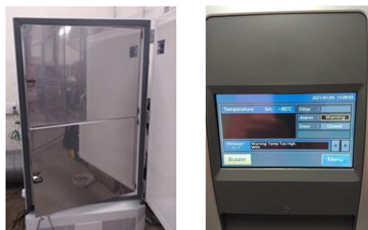
Рис. 4. Шкаф для хранения вакцин при -75^{\circ}\text{C} в больнице и приборная доска ©Cemafruid
