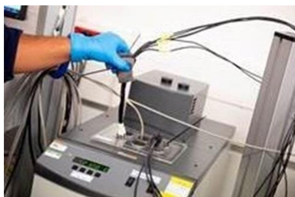
Рис.12. Метрологическая проверка температурного самописца внешним зондом ©Cemafruid
