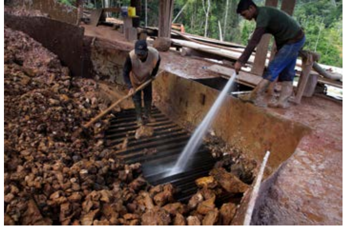
所展示的是一种新的摇床，只用水和重力来替代更常见的混汞法，从矿石中提取黄金。苏里南萨拉马卡区。 照片：Ranu Abhelakh/路透社
