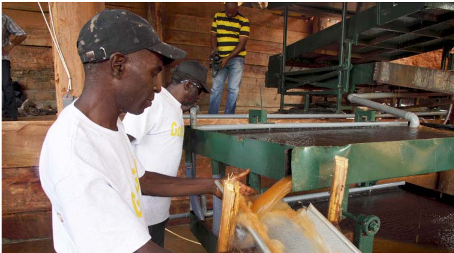
在苏里南萨拉马卡区的蓝水河矿区，一名金矿工人正在尝试使用无汞摇床提取黄金。 照片：Ranu Abhelakh/路透社
