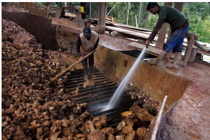
Démonstration d'une nouvelle table vibrante qui n'utilise que l'eau et la gravité pour extraire l'or du minerai, en remplacement de la méthode plus courante du mercure. District de Saramacca (Suriname).
