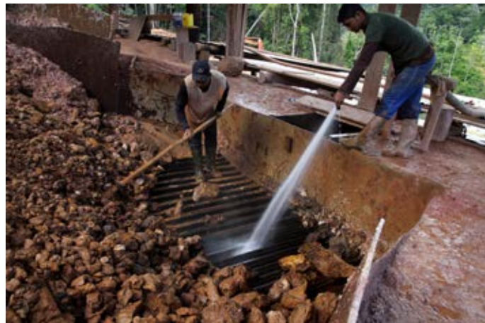
Demostración del funcionamiento de una nueva mesa vibrante que únicamente emplea agua y la fuerza de la gravedad, una alternativa al método más común de utilizar el mercurio para extraer el oro de los minerales. Distrito de Saramacca (Suriname). Fotografía: Ranu Abhelakh/Reuters
