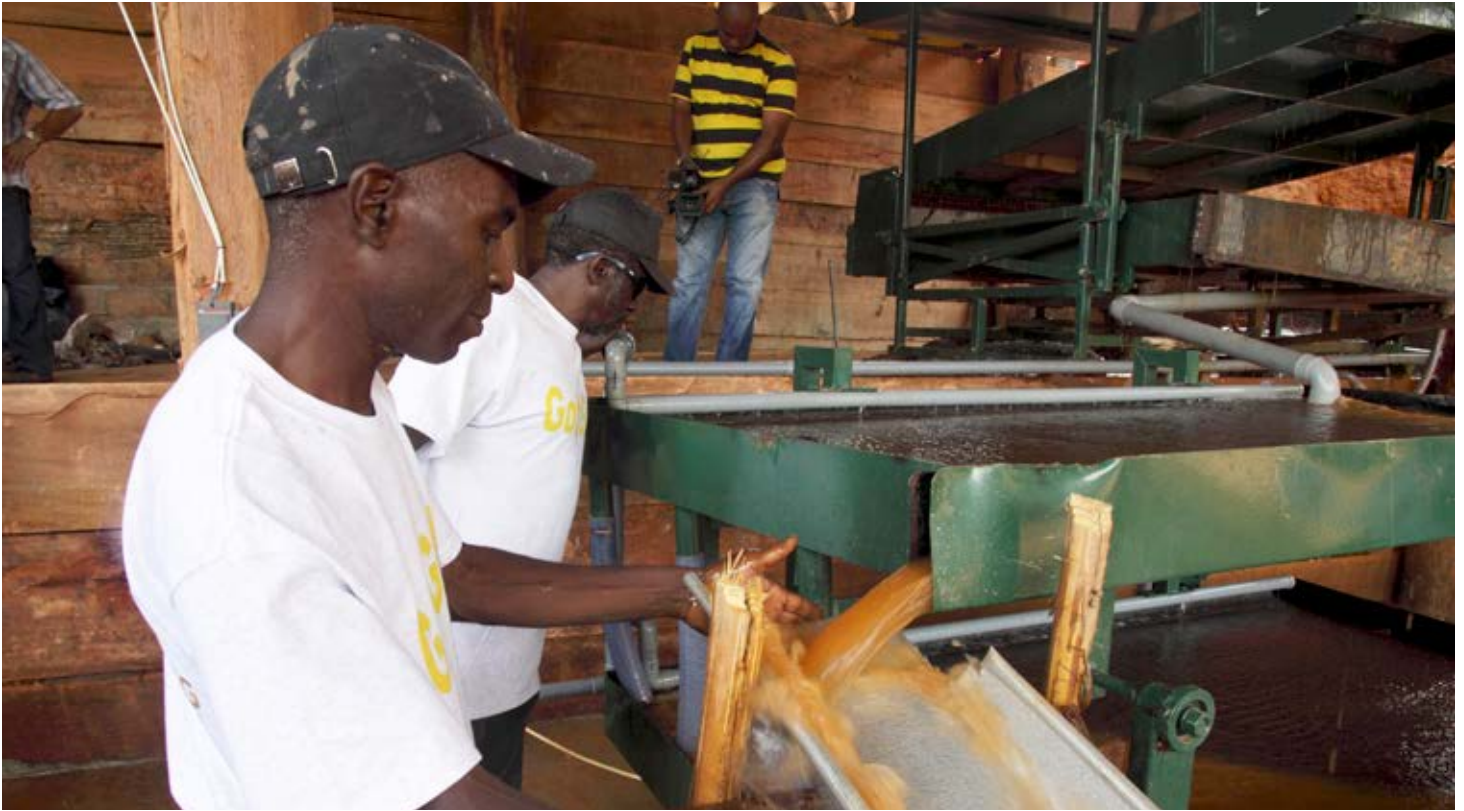
Trabajador de una mina de oro prueba una mesa vibrante sin mercurio para la extracción de oro en la mina de Aqua Azul del distrito de Saramacca (Suriname). Fotografía: Ranu Abhelakh/Reuters
