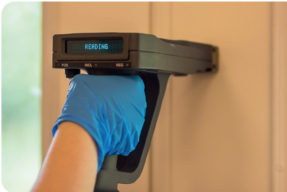
► Figura 4 - Inspección de la pintura con plomo con un dispositivo de espectrometría de fluorescencia de rayos X (XRF)
