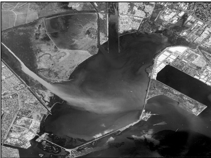
Figura 22. Comportamiento típico de la “pluma” de descarga de los sedimentos suspendidos del Río Cobre en Hunts Bay, Bahía de Kingston, Jamaica
