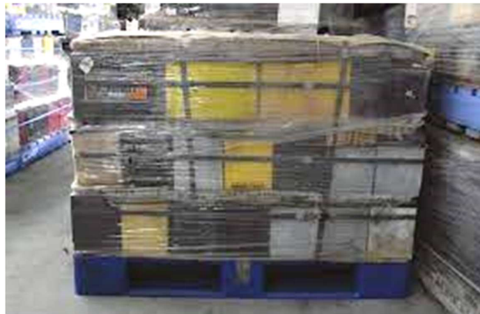
Figure 5 : BAPU empilés par taille avec des inserts en carton, sanglés et emballés sous film rétractable.
