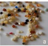
Des granulés de plastique industriels, généralement cylindriques mais parfois de formes sphériques ou cubiques ovales, ou des éléments industriels suspectés, utilisés pour les minuscules sphères (par exemple, vitreuses, laiteuses, etc.) |
