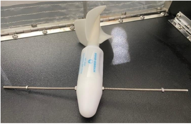
ម្ហូរដងប៊ូឡុងបញ្ចូលកាត់ក្បាលម៉ែត្រស្នងលំហូរទឹក ហើយម្ហូរខ្មៅទប់លំនឹងនៅទាំងសងខាង
