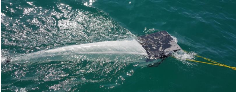
Figura 15: Ang malaking itim na parisukat na panel ay nasa itaas na bahagi ng lambat kapag nagsa-sample.
