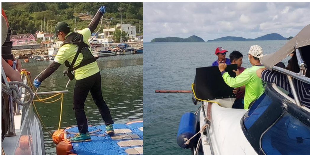
Figure 14: Mga halimbawa ng boom sa gilid ng mga bangka para sa pagkakabit ng lambat sa pamamagitan ng tow rope .
