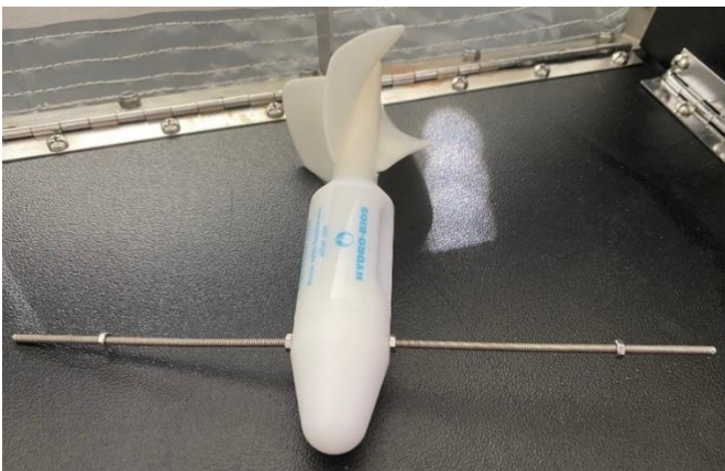
ร้อยก้านผ่านหัวของมิเตอร์วัดการไหลและยึดน็อตขนาดบางสองด้าน
