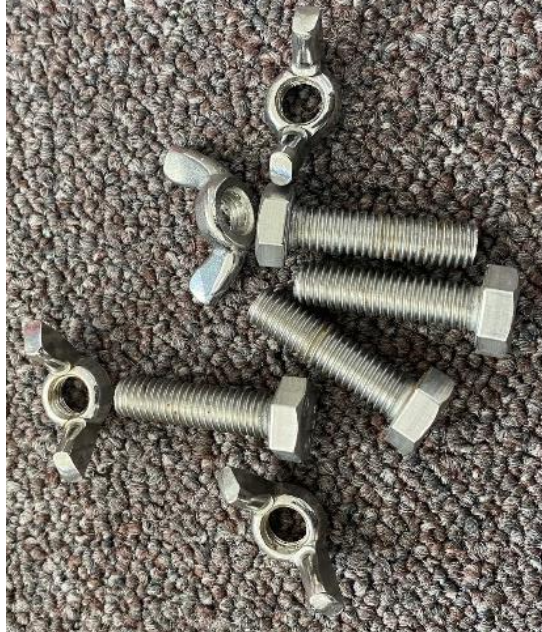
ชิ้นสลักเข้ากับแป้นเกลียวปีกเพื่อยึดขอบด้านข้าง
