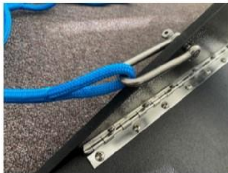
สเก็นทรงตัว D ที่ด้านข้างอวน ผูกปลายทั้งสองด้านของเชือกเข้ากับสเก็นทรงตัว D ทั้งสอง
