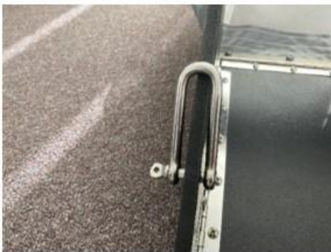
สเก็นทรงตัว D ที่ด้านข้างอวน ผูกปลายทั้งสองด้านของเชือกเข้ากับสเก็นทรงตัว D ทั้งสอง
