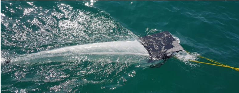
รูปที่ 15 แผงสี่เหลี่ยมสีดำขนาดใหญ่จะอยู่ด้านบนของปากอวนขณะสุมเก็บตัวอย่าง
