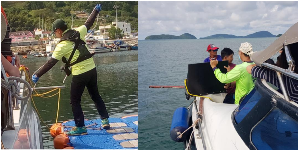
Hình 14: Ví dụ về cần ở mạn thuyền để gắn lưới kéo qua dây kéo.
