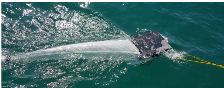
Hình 15: Tấm hình vuông lớn màu đen ở mặt trên của lưới khi lấy mẫu.
