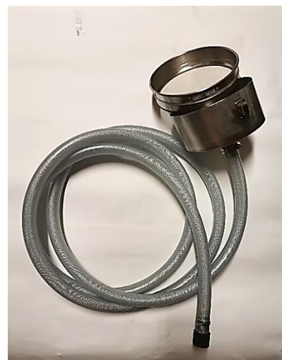
Figure 193 : Un tuyau en PVC doté d'un système de filtration avec un tamis en acier inoxydable (100 µm) (© IWRS, 2022).
