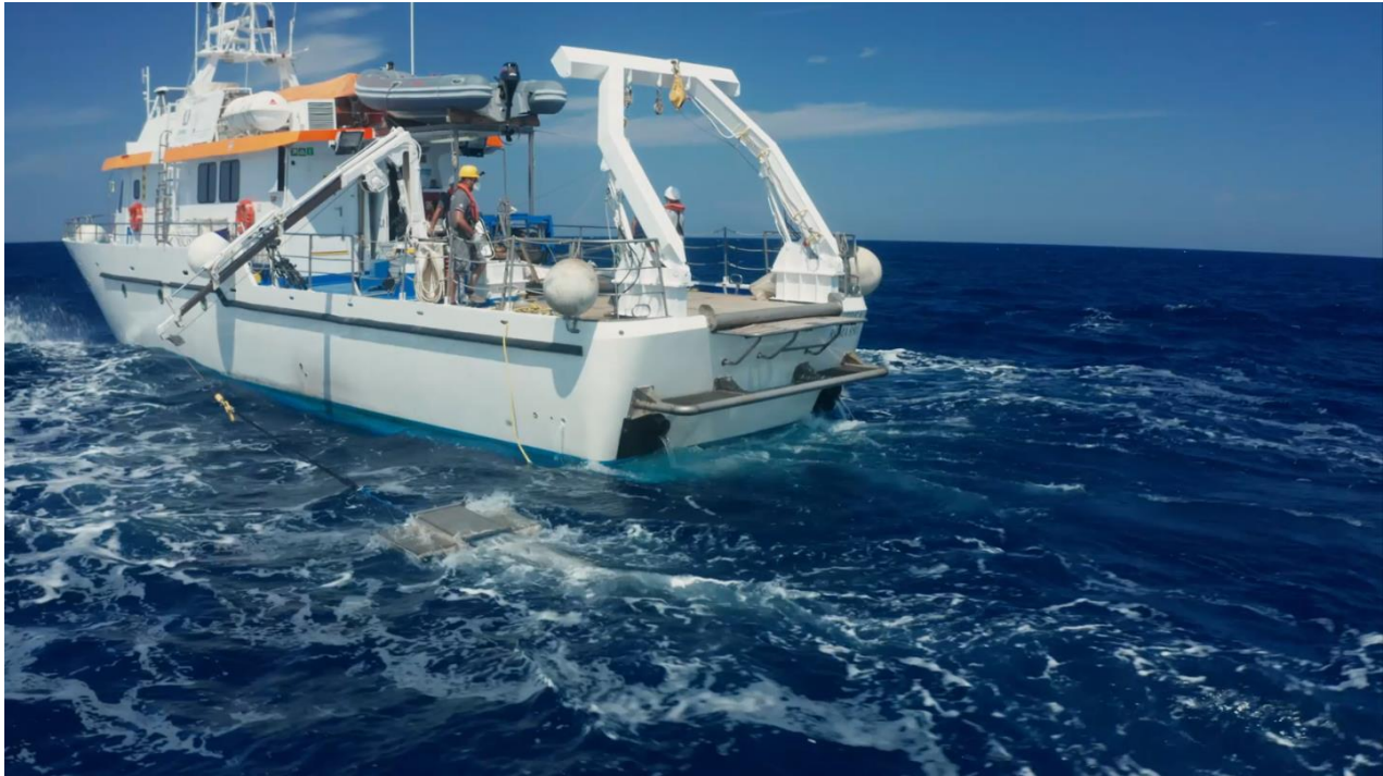
Figure 9 : Filet manta tracté sur le côté d'un bateau (Photo : © Cecilia Silvestri et Marco Matiddi, Italie)
