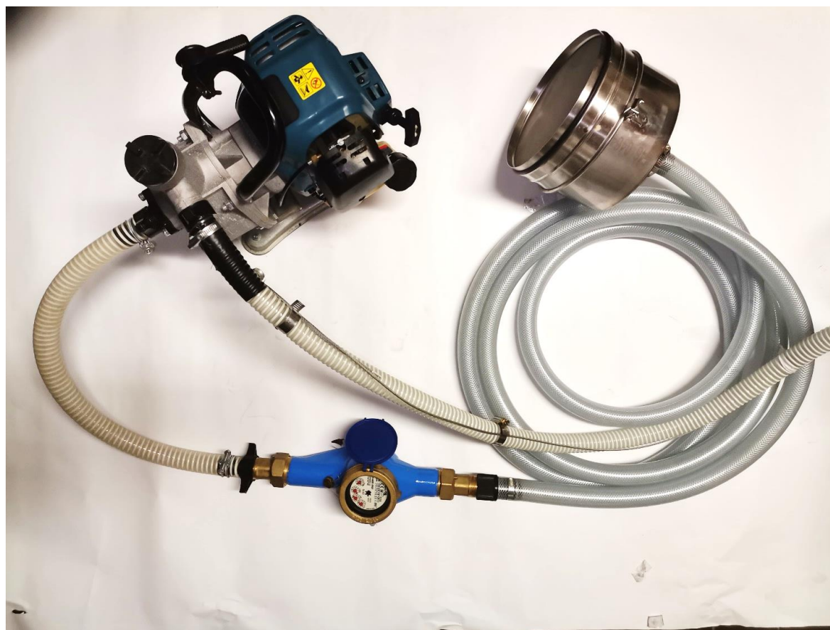
Figure 26 : Une petite pompe à eau légère équipée d'un débitmètre (© IWRS, 2022).
