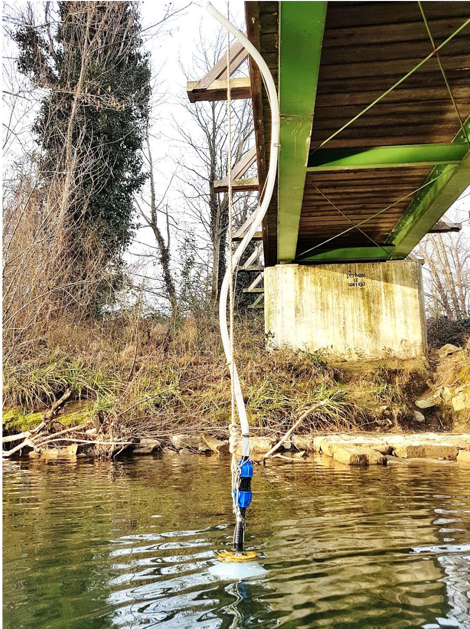
Figure 17 : Prélèvement de microplastiques à partir d'un pont, à l'aide d'une pompe à eau (© IWRS, 2020).
