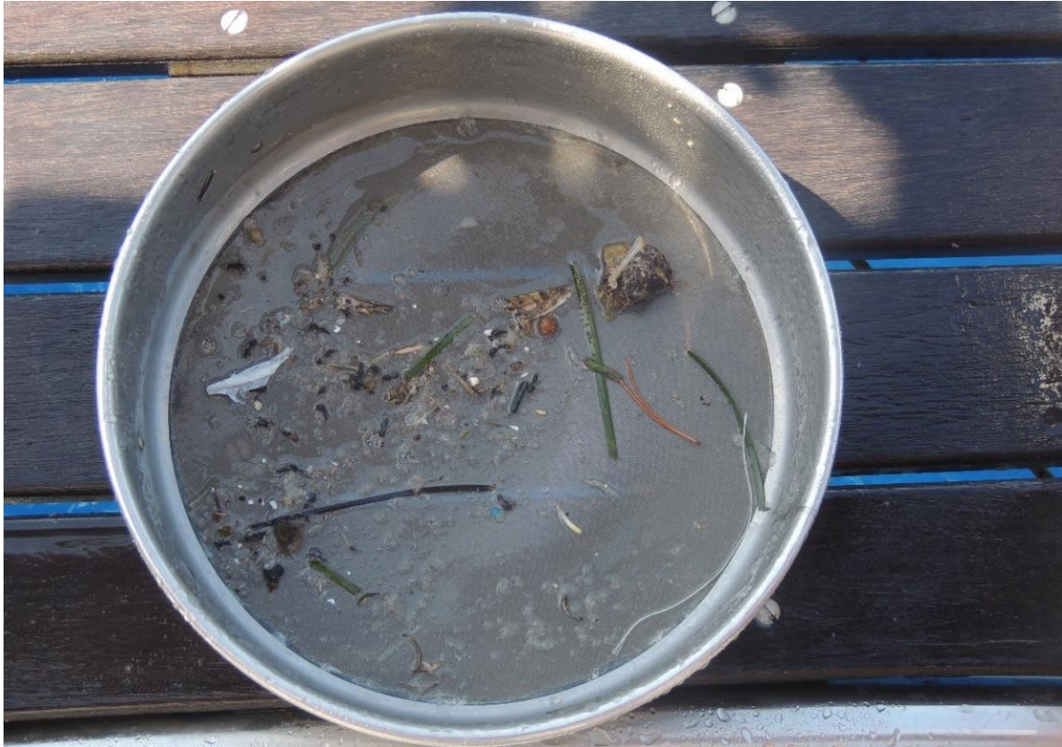
Figure 10 : Microplastiques et matières organiques recueillis dans un tamis en métal juste après le prélèvement (Photo : © Christos Ioakeimidis).
