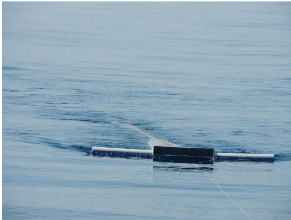
Figure 7 : Filet manta utilisé dans une mer calme, en dehors de la vague d'étrave causée par la rotation de l'hélice (Photo : © Christos Ioakeimidis, UNEP/PAM).
