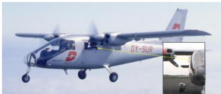
Fig. 5. Avion Partenavia P-68 Observer avec hublot bulle
