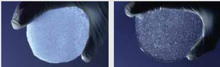
Izq.: un pedazo de testigo de hielo de poca profundidad, por el cual el aire puede circular libremente. Der.: un pedazo de hielo extraído a una profundidad de 120 metros, en el cual las burbujas de aire aprisionadas son claramente visibles. Abajo: investigadores científicos extraen un testigo de hielo de 10.000 años de antigüedad en la Antártida.
