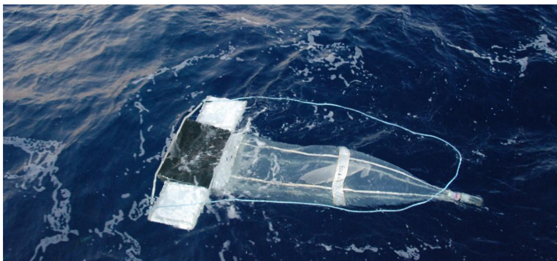
Рисунок 11.2 Буксируемая сеть “манта”, берущая пробы плавающего микропластика с поверхности океана (Новостной архив NOAA)
