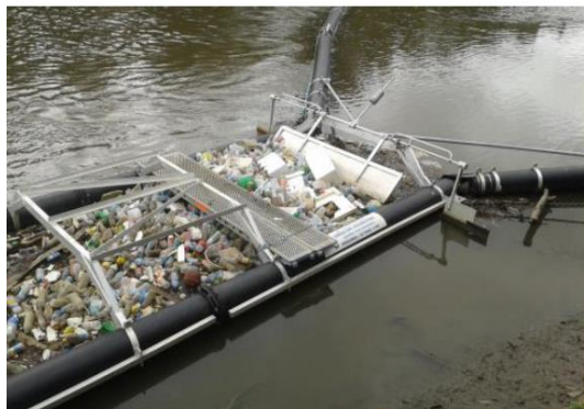
Рисунок 9.10 Два технических решения по задержанию плавучего пластика: а) Плавучая установка из сетей на реке в Австралии (Фото: Bandalong International Pty Ltd) и б) “Мистер Мусорное Колесо” – плавучее боновое заграждение с водяным колесом, работающее на энергии солнца и воды в заливе Балтимор в США (Фото: Адам Линдквист, Waterfront Partnership of Baltimore)
