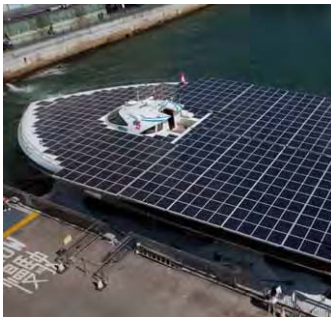
Türanor PlanetSolar, крупнейшая в мире лодка на солнечной энергии – покрытая 500 м 2 солнечных панелей – была первым транспортным средством на солнечной энергии, обогнувшим земной шар. © Tatiana Kakhill/iStock
