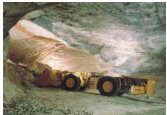
Loader (LHD-Load, hold, dump unit) - Kali und Salz GmbH, Germany
