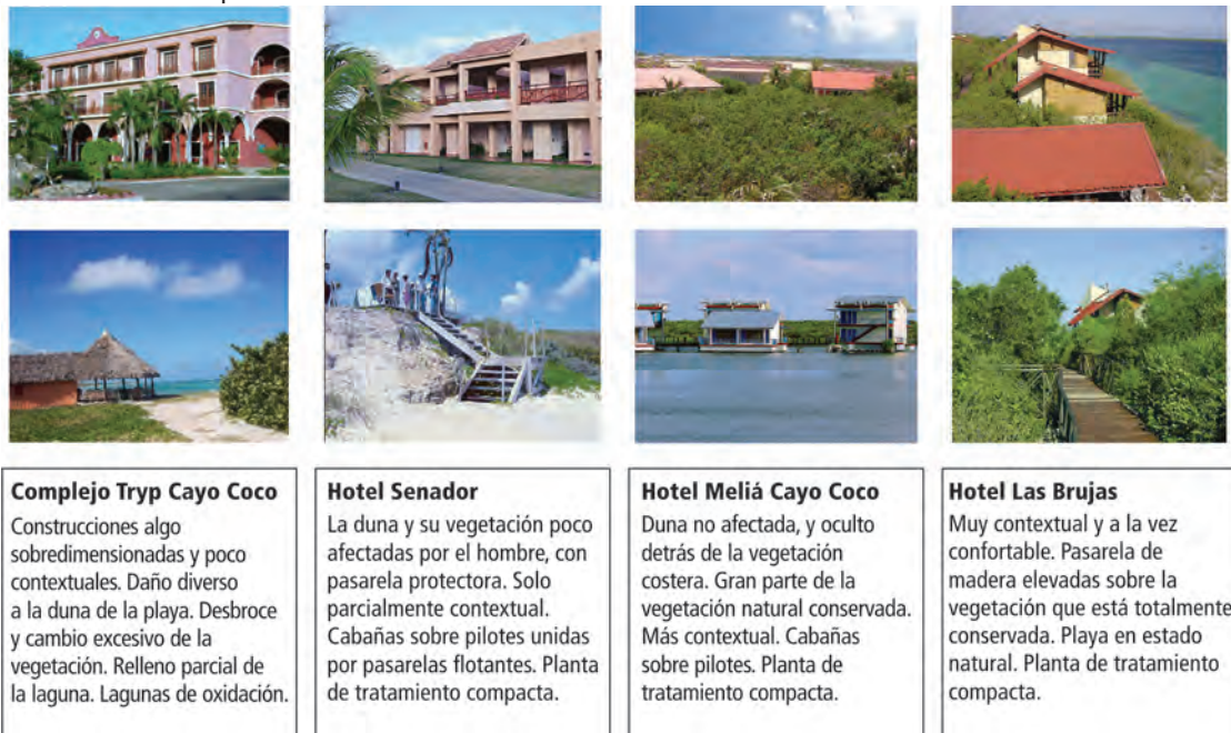
Fig. 4.17 Mejoras en el diseño y construcción de los hoteles más recientes a partir de las lecciones aprendidas con las primeras obras.
