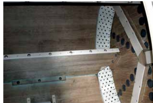
Fig. 3 : Les pales décentrées (non orientées vers l'axe) d'un foulon Cangilones permettent d'élever les peaux et le bain tout en haut du foulon avant de laisser retomber la masse sur les autres peaux, produisant ainsi un « effet éponge ».
