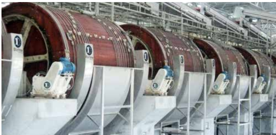
Figure 1. Les tout derniers foulons Cangilones Next d'Olcina Ø 4,2 x 4,5 m. (Photo cédées par le Gruppo Mastrotto - Italie)
