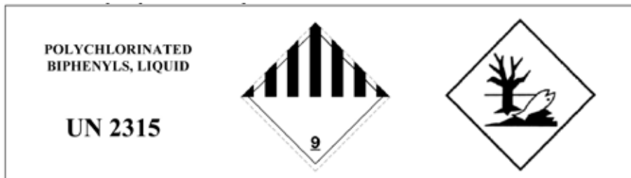
Photo 80 : Étiquetage des PCB liquides conforme au code IMDG
