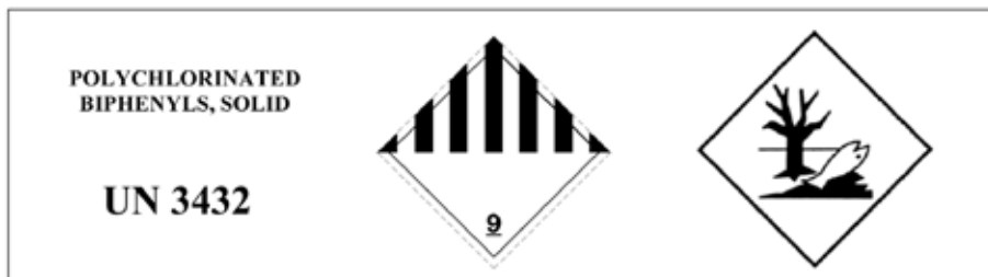
Photo 81 : Étiquetage des PCB solides conforme au code IMDG
