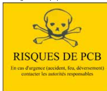
Photo 34: Vignette d'équipements soupçonnés de contenir des PCB
