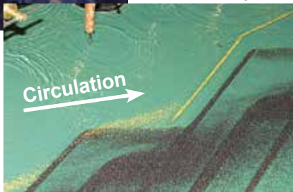
Photo: Grande table vibrante d'une petite usine de traitement sans mercure en Mongolie.
