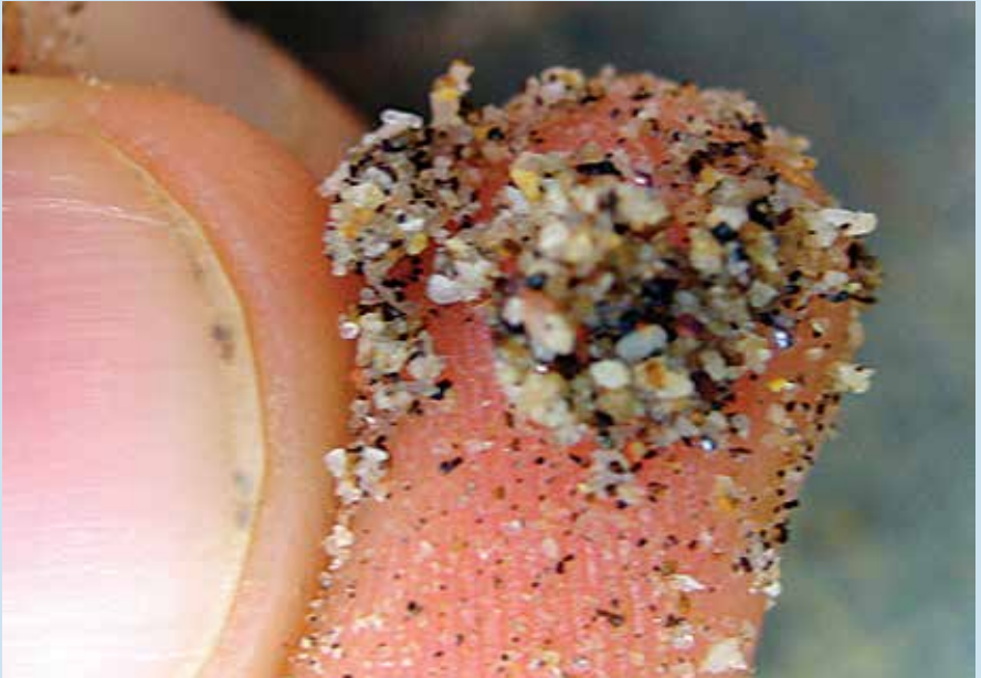
Petites gouttes de mercure visibles dans le minerai qui a été amalgamé (AMB), avant cyanuration.
